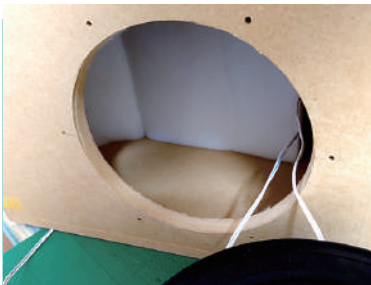
かなり音が響いていたので、クロスオーバー設定前だが少し吸音材を入れておいた。
