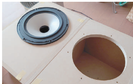
涼しい室内でのユニットの取り付け。スピーカーっぽくなってきた。
