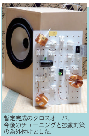
テストのクロスオーバは安物で音を探る。 ツイーターはホーン式なのでやんわり減衰 ウーファーは分割振動を軽減させる為、2KHzまで 頑張っって貰い3.5KHz以上は遠慮してもら
