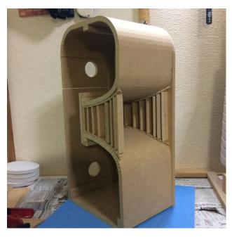
斜め前からの内部写真。左右ホーン部はハシ ゴ構造で製作しました。隙間は石粘土を充填。
