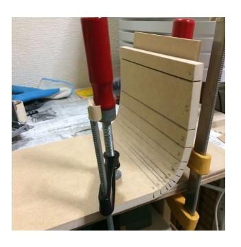
挽き曲げは小型丸ノコで0.5mmを残して溝を入れ、ボンドを流し入れて曲げ固めます。刃の厚みを底辺、溝の高さを両辺とした二等辺三角形として角度を計算します。しかし実際は誤差が大きく予定通りに曲げるのは大変でした。
