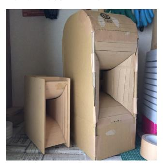
右はダンボールで製作したモックアップ。左の小さいものは5cmフルレンジの試作です。
