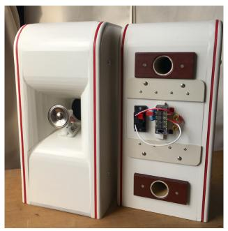
同軸ツイーターは可動式。ネットワークは背面 開口窓に露出。バスレフポートはサブバッフル式 で交換可能になっています。
