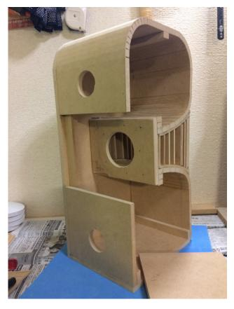
斜め後ろからの内部写真。ユニットは裏面から取り付け。背面に開口窓を設けています。
