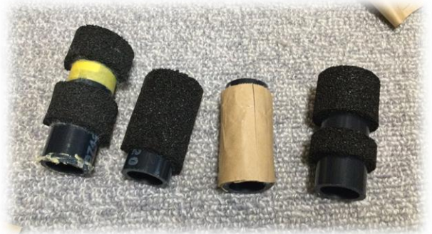
吸音材でダンブしたダクト達。 結局使わなかった。
