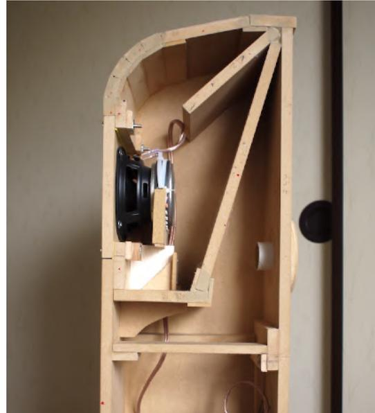
密閉部の背板を斜めに配置。補強板もテーパ形状に配置することで共鳴の低減と、反射面の多さによる効率的な減衰を狙いました。斜め板の接合面は4mmMDFで補強して隙間のないようにしています。
