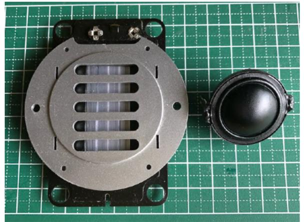
プリントリボン型（左）は裏面からも音が出るタイプ。前面カバーは樹脂製だが構造体の一部を構成しているので外して使用はできない。
