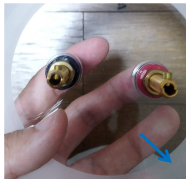
切り欠きのはみ出ている旧ターミナルプレート(5mm) 新ターミナルプレート(8mm・外周目粗し)
