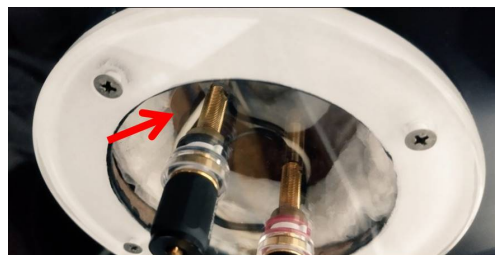
QAA シート投入した空気室
