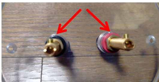
切り欠きのはみ出ている旧ターミナルプレート(5mm) 新ターミナルプレート(8mm・外周目粗し)
