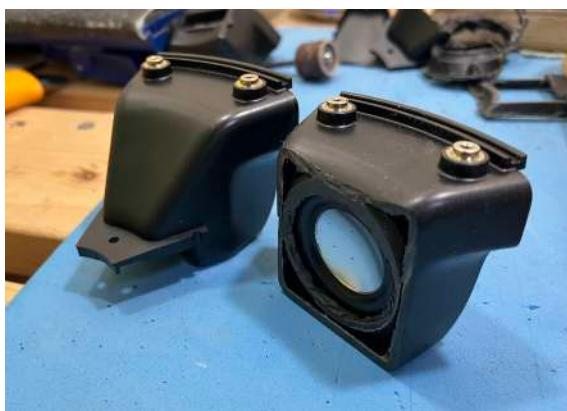
今回のツイーターも前作同様、NFJで販売されている某A社の旧HomePod内蔵ビームフォーミングツイーターです。殻を割ってイコライザ部を除去、自作WG兼マウンタに接着します。ユニット背面のビスでハウジング内部のユニット本体を後ろから押し付けて固定しています(左下画像)
