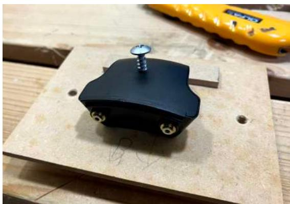
右：WGは希望の曲線に合わせたリング状のMDFを積層に接着。自作の回転台に装着してリューターで切削加工します。
