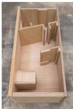
● 2つの空気室の仕切りには角度を付けて、天地方向に発生する定在波の緩和を目指しています。
